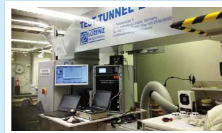
●EN規格(欧州の統一規格)対応 熱/煙循環試験機 煙感知器及び熱感知器の感度を測定するための装置です。
