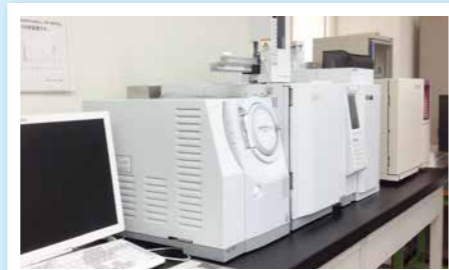
●カスケロマトグラフ質量分析装置 製品に吸着した物質を分析し、センサの感度変化の原因を見つけます。
