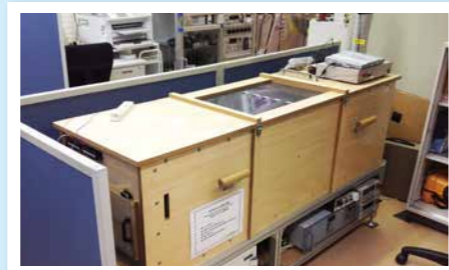
●UL規格(米国の製品安全規格)対応煙循環試験機 煙感知器の感度を測定するための装置です。
